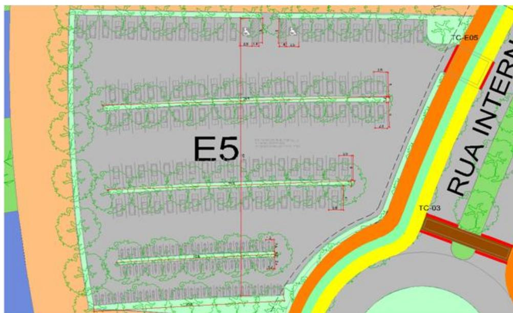
**FIGURA 24: Estacionamento (E5) na forma de bolsão para automóveis e motocicletas.**
